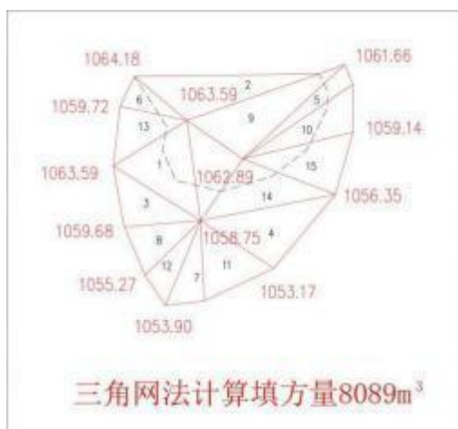
图4-2 SJ2废石场填方量三角网法计算成果图
